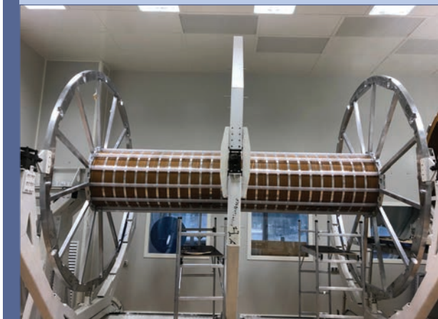
Склейка двух фланцев и высоковольтного электрода с трубой C1–C2
