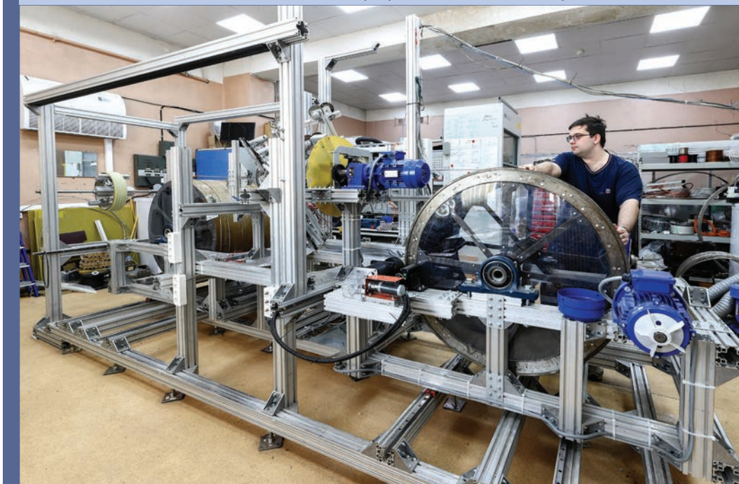
Установка для намотки ВТСП-магнитов. Профилактический осмотр основы для магнита
