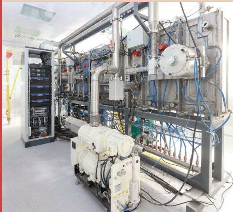
Установка по магнетронному напылению пленок карбида бора на подложки из различных материалов
