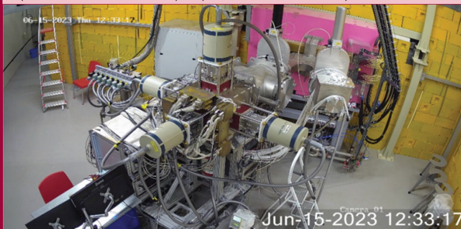
Комбинированная детектирующая система GABRIELA-III в фокальной плоскости сепаратора GRAND (DGFRS-3) Фабрики СТЭ
