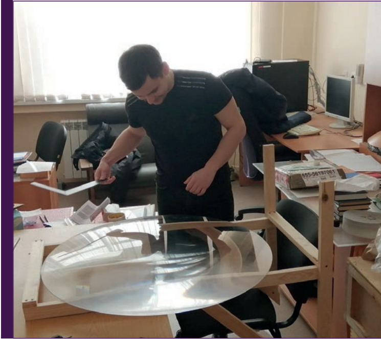
Пластиковая линза диаметром 820 мм для прототипа детектора эксперимента TAIGA
