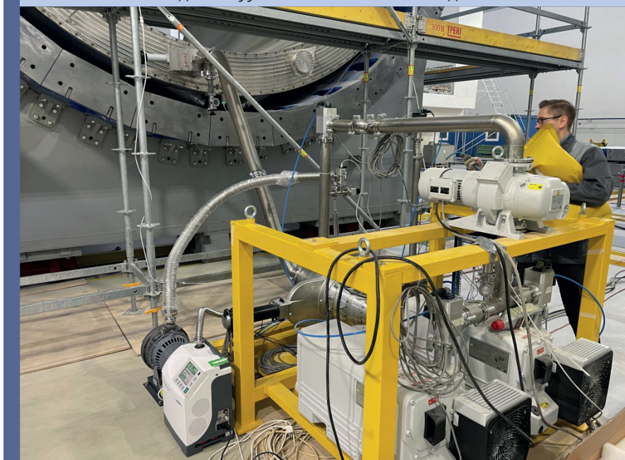
Испытания и наладка вакуумной системы соленоида
