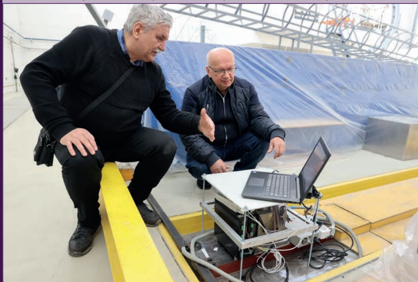
Лаборатория физики высоких энергий им. В. И. Векслера и А. М. Балдина. Установка двух малогабаритных лазерных инклинометров в зале MPD NICA
