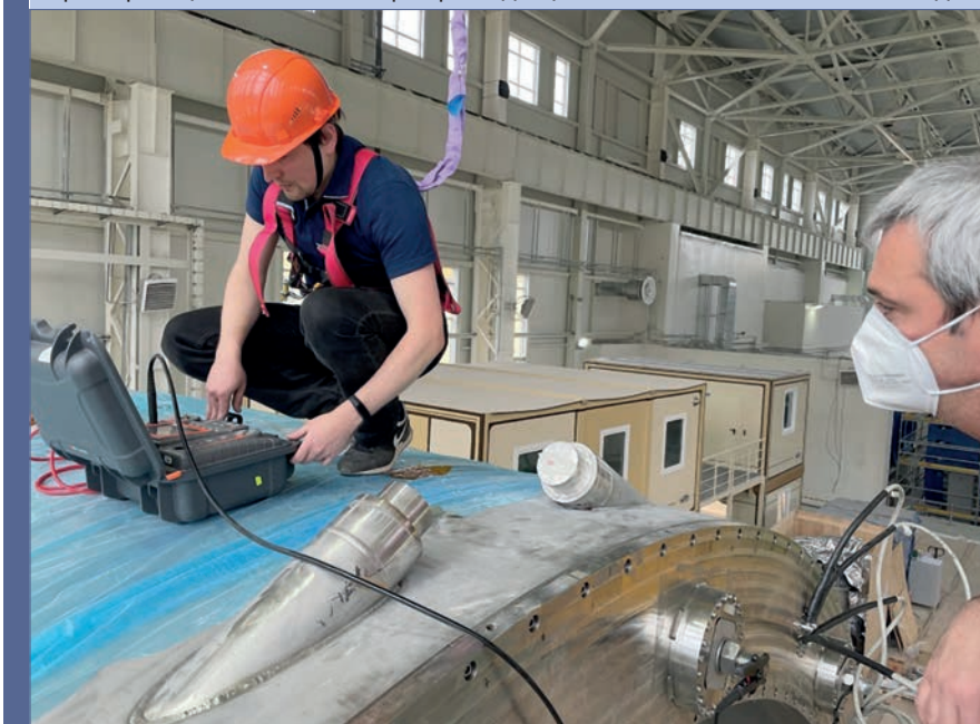
Проверка целостности сверхпроводящих кабелей обмотки соленида
