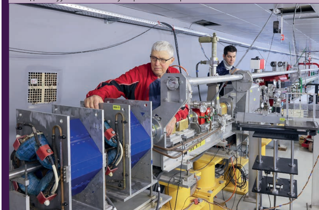
Наладка вакуумной системы ускорителя электронов Линак-200
