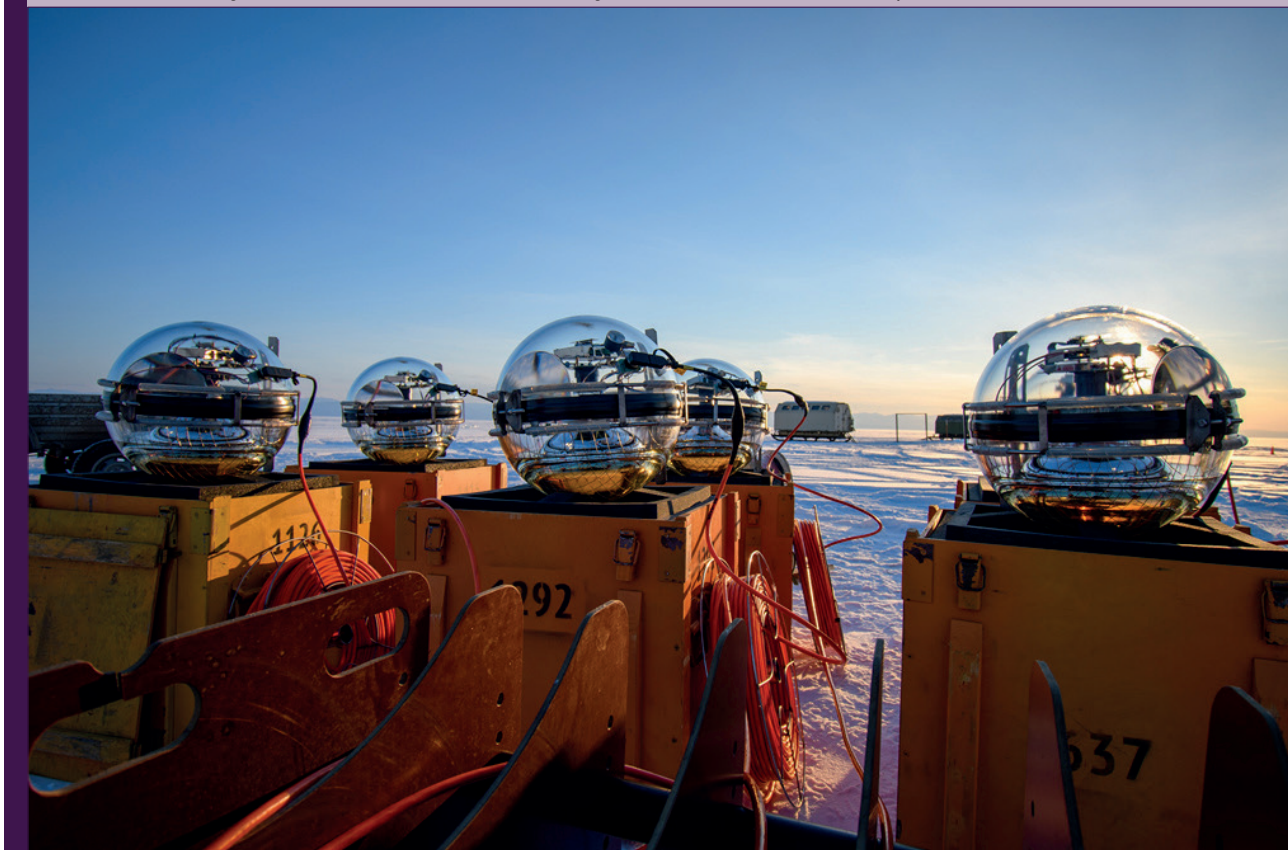
Байкал (Россия), март. Ледовый лагерь. Оптические модули, подготовленные к монтажу нового, девятого кластера
